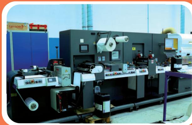
Linea di stampa ad alta tecnologia per la conversione e la finitura di etichette autoadesive in bobina. Per conversione si intende la fustellatura con impiego di tecnologia laser, il rifilo ed il taglio con l'impiego di lame in acciaio. Per finitura si intende la verniciatura UV con l'utilizzo di modulo flessografico.
