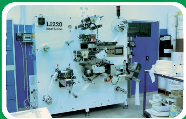
Macchina per etichette multistrato, finiture e controllo. Grazie a sistemi di videoispezione, cioè sistemi di controllo, possiamo correggere gap tra etichette in fase di pre stampa o stampa, quindi possiamo ridurre gli sprechi. Applicazione nuove tecnologie come RFID su etichette adesive.
