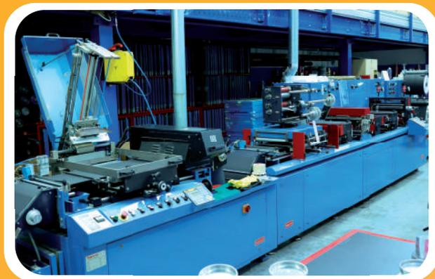
Sono macchine combinate per finiture: comprendono moduli serigrafici, moduli per la stampa a caldo e un modulo fustellatore.
